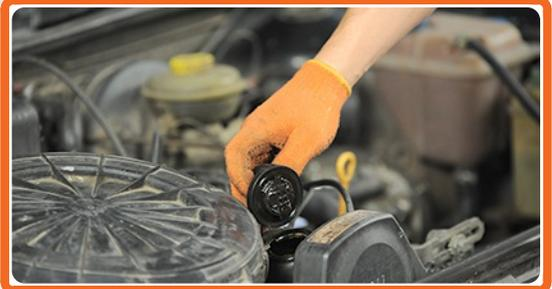
Füllen Sie den Motor mit Öl durch den Ölfilter.
