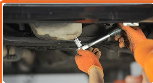
Setzen Sie die Ablassschraube an die richtige Stelle und ziehen Sie diese an.
