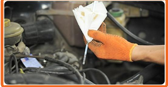
Überprüfen Sie den Ölstand 5 Minuten nach dem Anhalten des Motors, verwenden Sie einen Peilstab und fügen Sie - wenn nötig - Öl hinzu.
