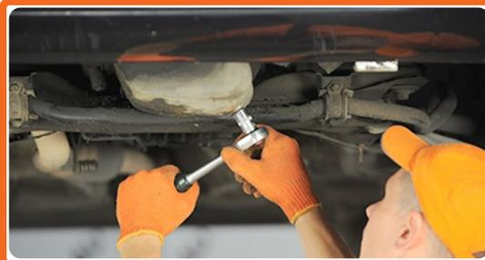
Lösen Sie die Ablassschraube um eine halbe Umdrehung.
